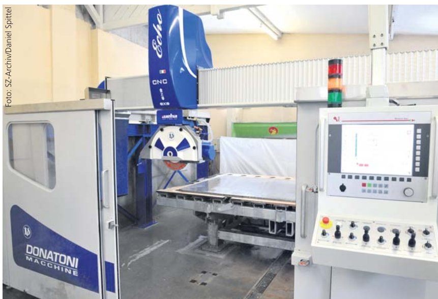
Die Drehkopfbrückensäge im Bauzentrum Willkommen kann Steine millimetergenau sägen, bohren oder fräsen. Somit lassen sich alle Materialien vor Ort nach Wunsch konfektionieren.
